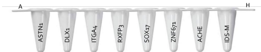
Abbildung 3 Aufbau der GynTest® Strips
